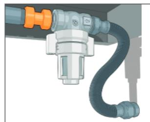
Il collegamento del filtro cod. 545910 direttamente alla caldaia può essere realizzato sia in configurazione verticale sia in configurazione orizzontale. Codolo con calotta mobile presente a corredo.
